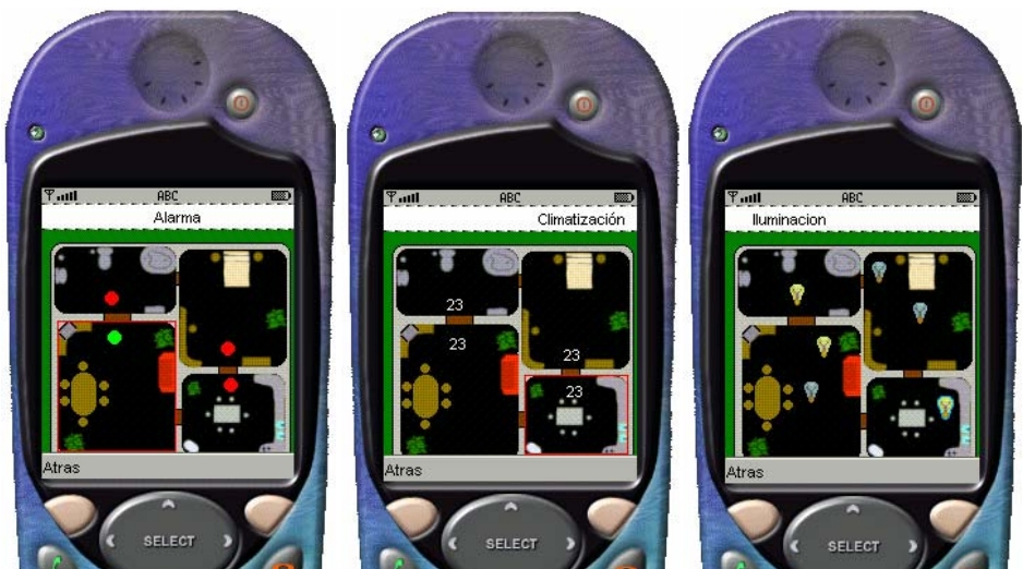
Figura 5.16 Visualización de Alarma, Climatización y Luces, respectivamente
